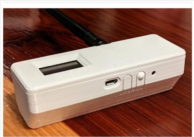
TBEAM Gehäuse mit Tasten und OLED
