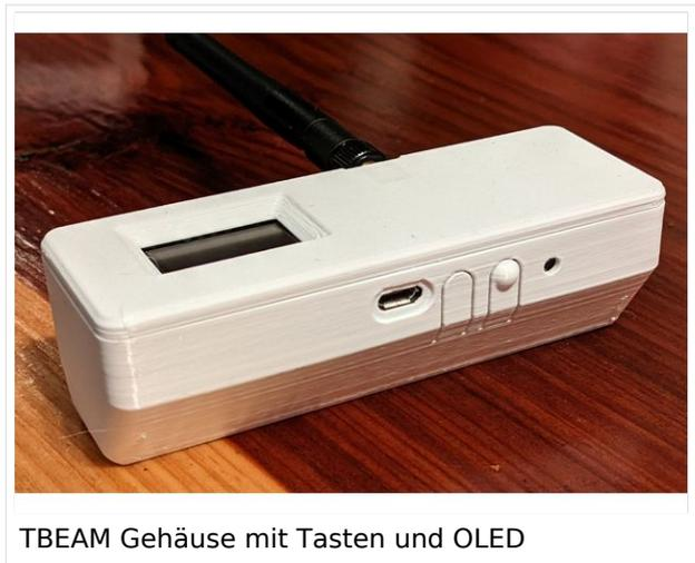
TBEAM Gehäuse mit Tasten und OLED
