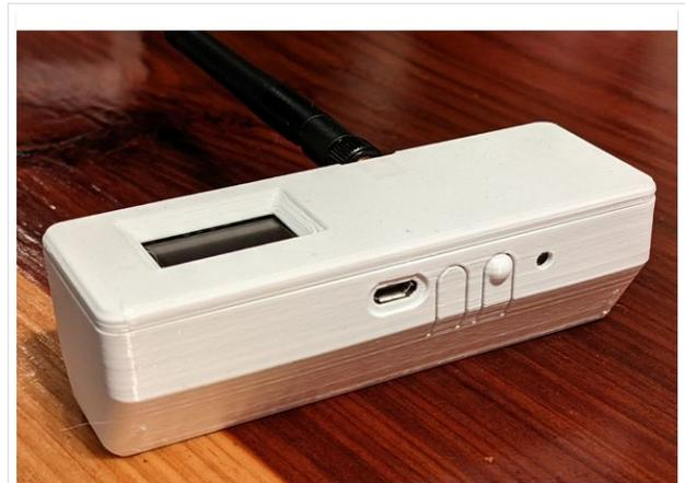
TBEAM Gehäuse mit Tasten und OLED
