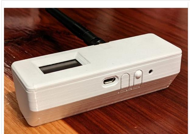
TBEAM Gehäuse mit Tasten und OLED
