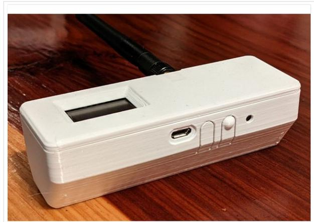
TBEAM Gehäuse mit Tasten und OLED
