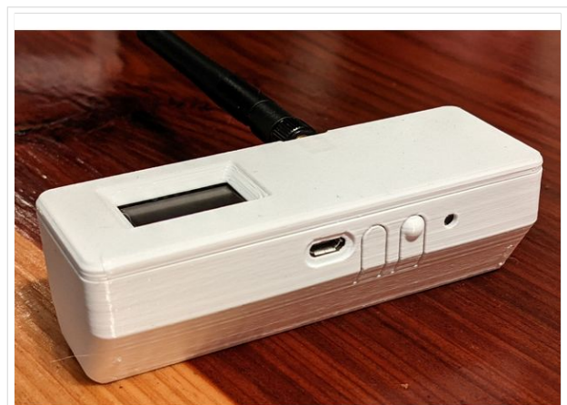
TBEAM Gehäuse mit Tasten und OLED
