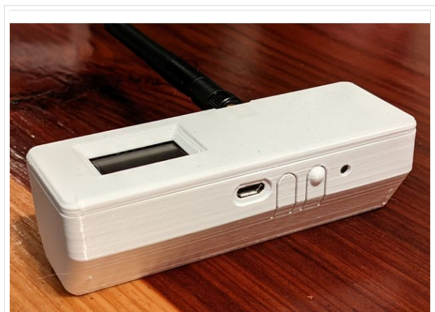
TBEAM Gehäuse mit Tasten und OLED
