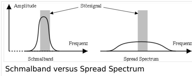
Dieses Projekt wurde ja bereits von längerer Zeit ausgerollt und hat sehr gut zum Verständnis dieser Übertragungstechnologie beigetragen. Es werden HAM-IoT-Module mit einem 70cm LoRa-Chip verwendet. So werden heute, nicht nur in OE, für die Übertragung der GPS-Pakete im OE-LoRa-Format Frequenzen von 433.775 MHz für den Uplink zum LoRa-
