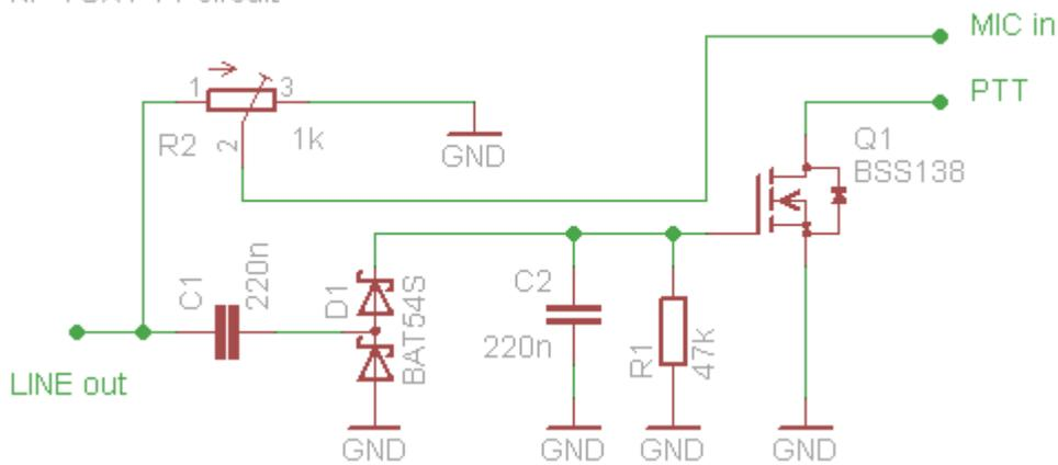
Diese Schaltung hat den Vorteil, dass sie ohne externe Spannungsversorgung auskommt.
