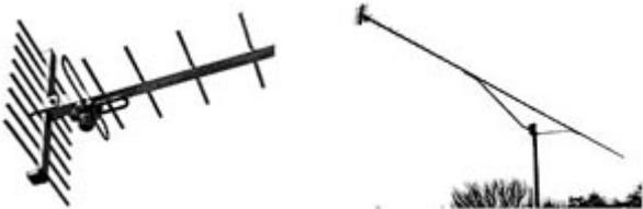
Der Klassiker unter den Antenne ist die YAGI-Antenne.
