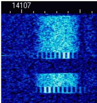
Beispiel eines Packet-Signals mit 300 Baud im Wasserfall-Display von MixW
