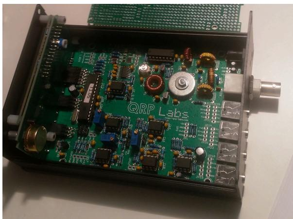
Der [QCX+](#) (**QRP CW Xcvr +**) ist ein monobandiger 5W, Morse-Transceiver als Bausatz mit eingebauter [WSPR](#) Bake, sowie Abgleichshilfe und Systemtest. Der Bausatz ist erhältlich für 80, 60, 40, 30, 20 oder 17m Band. Neben dem ursprünglichen [QCX](#) Bausatz (2017) gibt es zwei weitere Varianten: [QCX+](#) (seit Juni 2020) und [QCX-mini](#) (seit Dezember 2020). Siehe [QRP-Labs Webseite](#).
