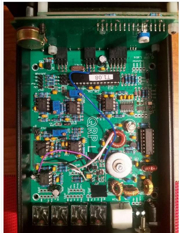
QCX+ mit eingebautem AGC Kit von qrp-labs mit Firmware Update 1.08. Das Kit basiert auf dem Schaltungsentwurf von Jim AJ85
