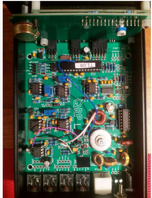
QCX+ mit eingebautem AGC Bausatz von grp-labs mit Firmware Update 1.08. Der Bausatz basiert auf dem Schaltungsentwurf von Jim AJ85
