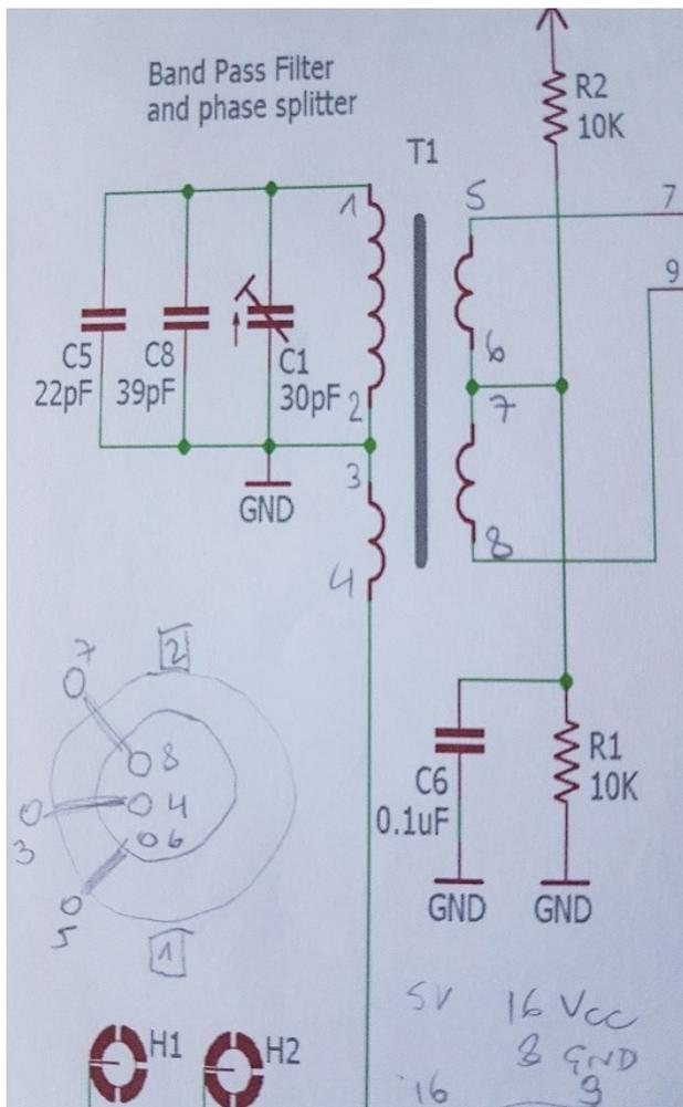
Nun mit einem Meßgerät (Vielfachmessgerät - auf akustischen Ton bei Kurzschluß gestellt) überprüfen, ob alle Verbindungen stimmen und keine Kurzschlüsse oder schlechte Lötverbindungen vorhanden sind. Wie man aus dem Ausschnitt des Schaltbildes sehen kann, sollten bei den Punkte 1-2-3-4 eine Verbindung vorhanden sein. Ebenso zwischen 5-6-7-8.
