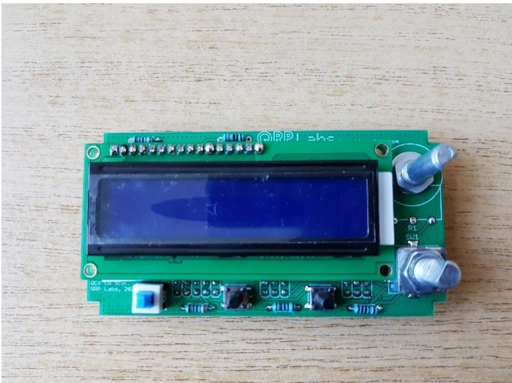
Wenn man dann eigentlich alles montiert hat und schon das Gerät einschalten will, sollte man sich noch die Zeit leisten und das Wichtigste tun – nämlich **alle Lötstellen mit der Lupe überprüfen**. Auch wenn man wirklich gut löten kann, bilden sich immer kleine Lötkekeln, welche Kurzschlüsse verursachen können und welche man am besten mit einer dünnen Nadel entferne sollte. Die Lötbrücken am besten wegsaugen.
