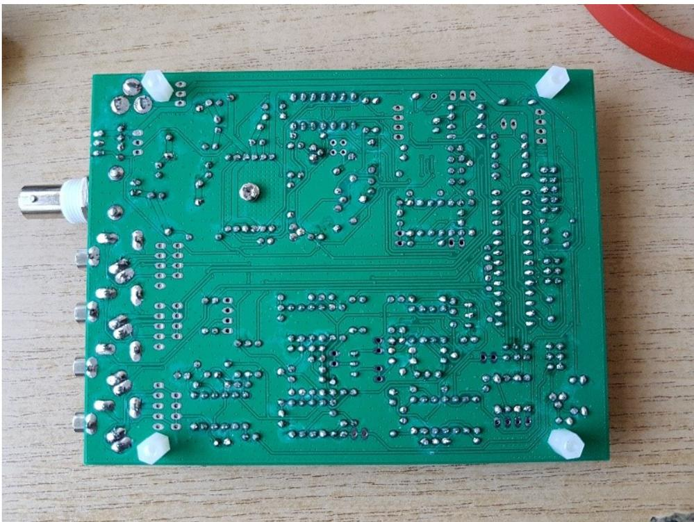
Nachdem ich nun beide Teile zusammengesteckt habe wurde die Kunstantenne angeschlossen. Das Netzgerät auf 11V gestellt und gehofft, dass der „Smoke Test“ gelingt.
