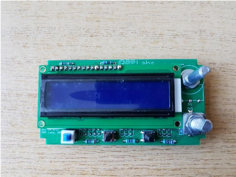
Wenn man dann eigentlich alles montiert hat und schon das Gerät einschalten will, sollte man sich noch die Zeit leisten und das Wichtigste tun – nämlich **alle Lötstellen mit der Lupe überprüfen**. Auch wenn man wirklich gut löten kann, bilden sich immer kleine Lötkegel, welche Kurzschlüsse verursachen können und welche man am besten mit einer dünnen Nadel entfernen sollte. Die Lötbrücken am besten wegsaugen.
