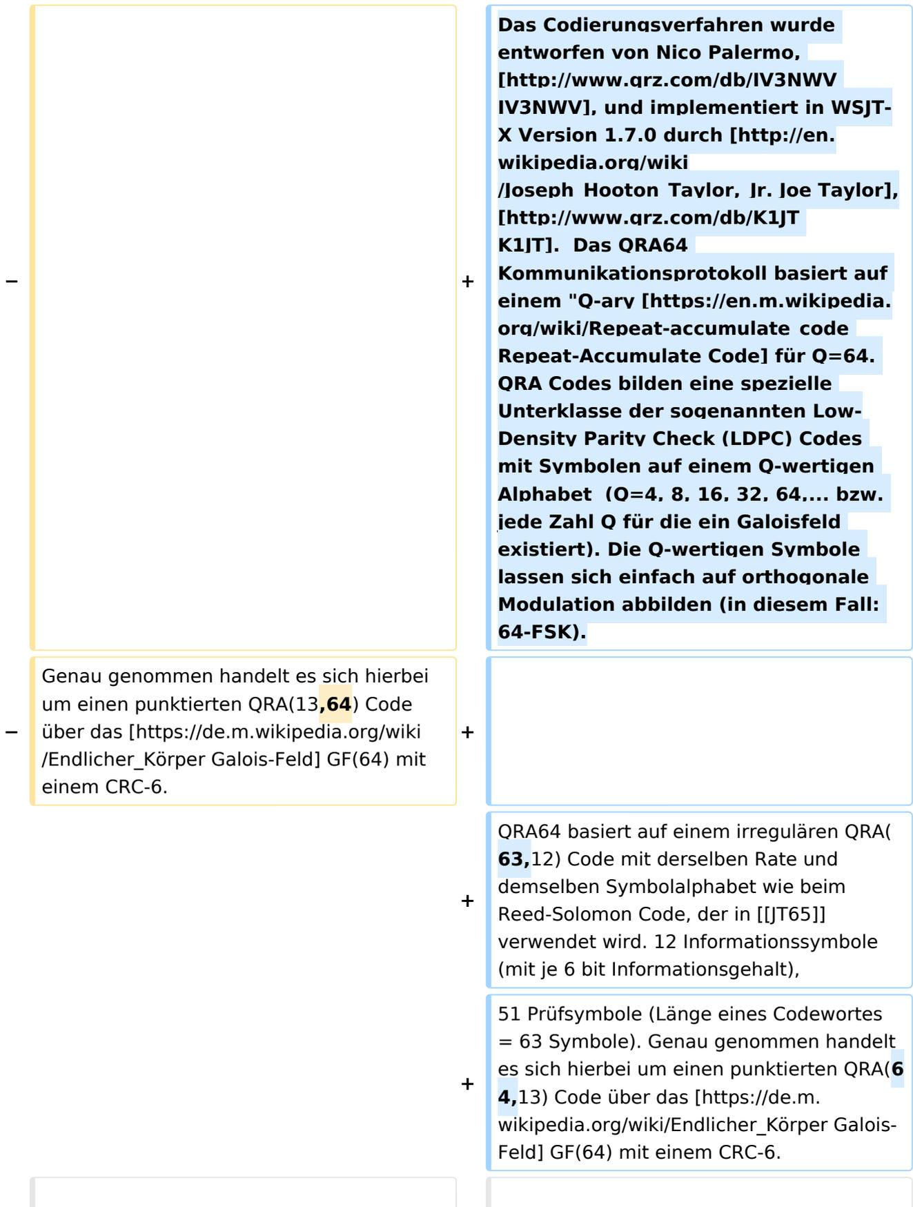
Decodiert wird nach dem MAP Kriterium (Maximum A-Posteriori Probability) mit Hilfe eines iterativen Message Passing (MP) Algorithmus.
