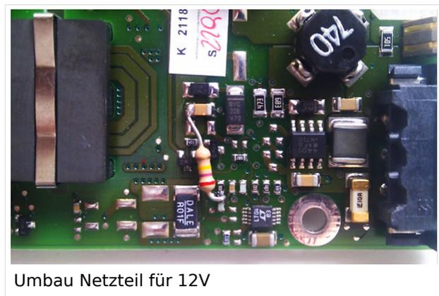
Umbau Netzteil für 12V
