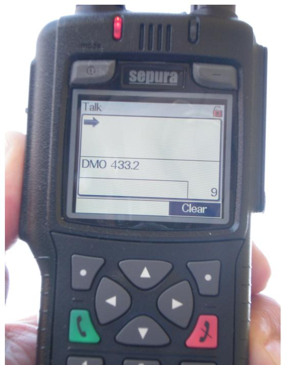
Die Geräte unterstützen auch das Senden von Kurznachrichten (SDS) und der GPS-Position. Eine Vernetzung von TETRA mit anderen Netzen ist via SIP- Gateway (VOiP) z.B. ALLSTAR (Asterisk) oder TEAMSPEAK möglich.
