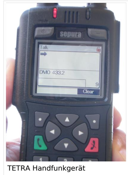
Die Geräte unterstützen auch das Senden von Kurznachrichten (SDS) und der GPS-Position. Eine Vernetzung von TETRA mit anderen Netzen ist via SIP- Gateway (VOiP) z.B. ALLSTAR (Asterisk) oder TEAMSPEAK möglich.
