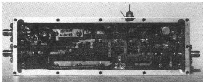
1993 beschrieb Sam Jewell, G4DDK, im DUBUS Magazin 3/93 sowie im DUBUS Technik BUCH IV seinen Transverter. Das System bestand aus mehreren Einzelbaugruppen und Leiterplatten. Die Baugruppen waren auch als Bausatz (von G3WDG) erhältlich.
