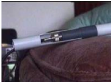
Schnitt Antennenfuß mit Mastrohr und SOT Anschluß
