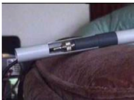
Schnitt Antennenfuß mit Mastrohr und SOT Anschluß
