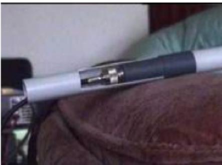
Schnitt Antennenfuß mit Mastrohr und SOT Anschluß
