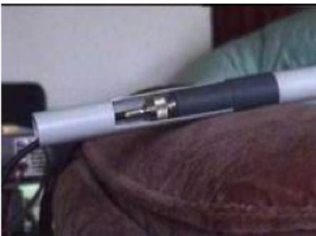
Schnitt Antennenfuß mit Mastrohr und SOT Anschluß
