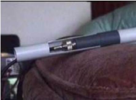
Schnitt Antennenfuß mit Mastrohr und SOT Anschluß
