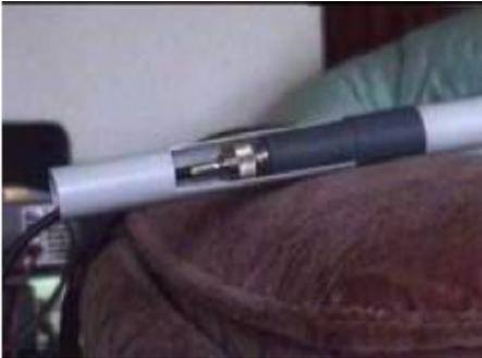
Schnitt Antennenfuß mit Mastrohr und SOT Anschluß
