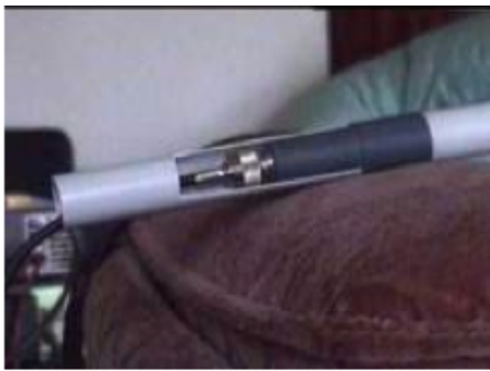
Schnitt Antennenfuß mit Mastrohr und SOT Anschluß
