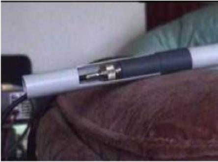
Schnitt Antennenfuß mit Mastrohr und SOT Anschluß
