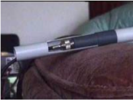
Schnitt Antennenfuß mit Mastrohr und SOT Anschluß
