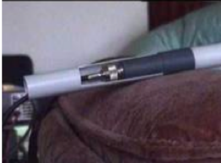
Schnitt Antennenfuß mit Mastrohr und SOT Anschluß
