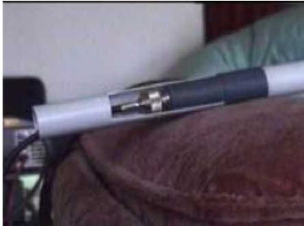
Schnitt Antennenfuß mit Mastrohr und SOT Anschluß
