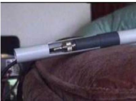
Schnitt Antennenfuß mit Mastrohr und SOT Anschluß
