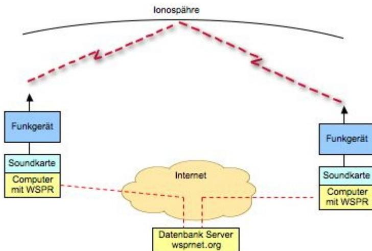
Das Weak Signal Propagation Reporter Network ist eine Gruppe von Funkamateuren welche K1JT's Programm WSPR (ausgesprochen "whisper" - "Weak Signal Propagation Reporter") nutzen um die Ausbreitungsbedingungen durch Aussendungen mit sehr geringer Leistung (QRP/QRPP) zu erforschen.
