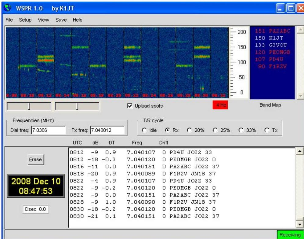
Das Programm WSPR r die Möglichkeiten einer Sound Karte für die Send und Empfangsfunktion WSPR erzeugt und empfängt Signale mitte strukturierter Nachricht und einer leistungsfähig Vorwärts Korrektur basierend auf einer 4-F Modulation. Das Ziel der Entwicklungsanstrengung war es sehr schwache Signale zu decodieren. In der Praxis arbeitet das System gut bis zu Signal Rauschabstände von -2 bei einer Referenzbandbreite von 2500Hz.
