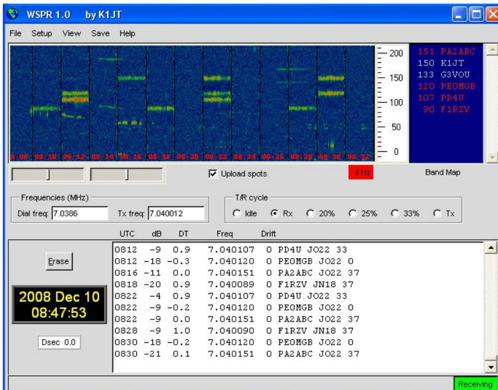
Das Programm WSPR r die Möglichkeiten einer Sound Karte für die Send und Empfangsfunktion WSPR erzeugt und empfängt Signale mittels strukturierter Nachrichten und einer leistungsfähigen Vorwärts Korrektur basierend auf einer 4-F Modulation. Das Ziel der Entwicklungsanstrengung war es sehr schwache Signale zu decodieren. In der Praxis arbeitet das System gut bis zu Signal Rauschabständen von -2 bei einer Referenzbandbreite von 2500Hz.
