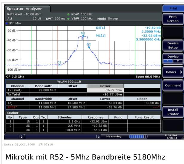
Mikrotik mit R52 - 5Mhz Bandbreite 5180Mhz
